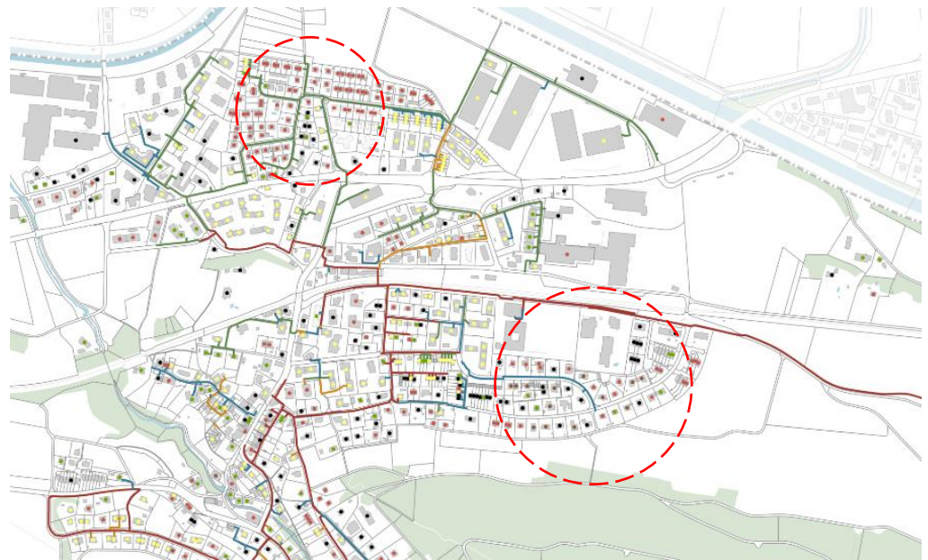
Abbildung 6: Darstellung der unterschiedlichen Heizstypen und die Gasleitungen nach Verlegjahr in der Gemeinde Pfungen. Die Gebiete Pfungen Nord und Schibenacher / Bettlen sind Bereiche, in welchen ein Gasnetz besteht, aber keine oder kaum Gaskunden mehr angeschlossen sind (vgl. rote Umrandung).
